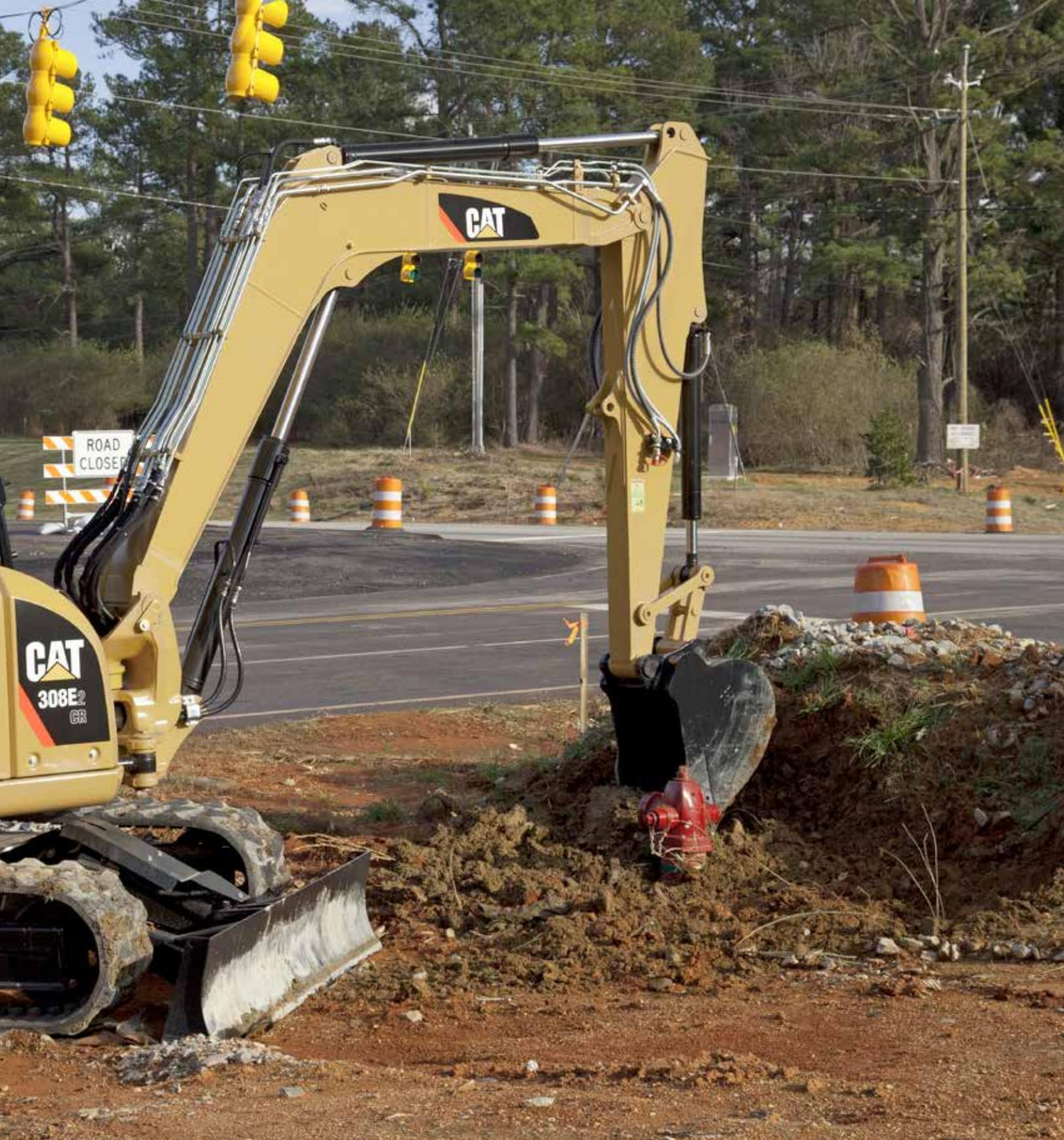
**Il miniescavatore idraulico Cat 308E2 CR SB offre alte prestazioni unite alla versatilità di un leverismo anteriore con braccio oscillante e un robusto design a raggio compatto per far fronte alle applicazioni più impegnative. Grazie al pannello del display COMPASS, al motore Tier 4 Final (Stage IIIB) e al nuovo impianto idraulico, il modello 308E2 CR SB garantisce livelli superiori di produttività, versatilità ed efficienza.**
